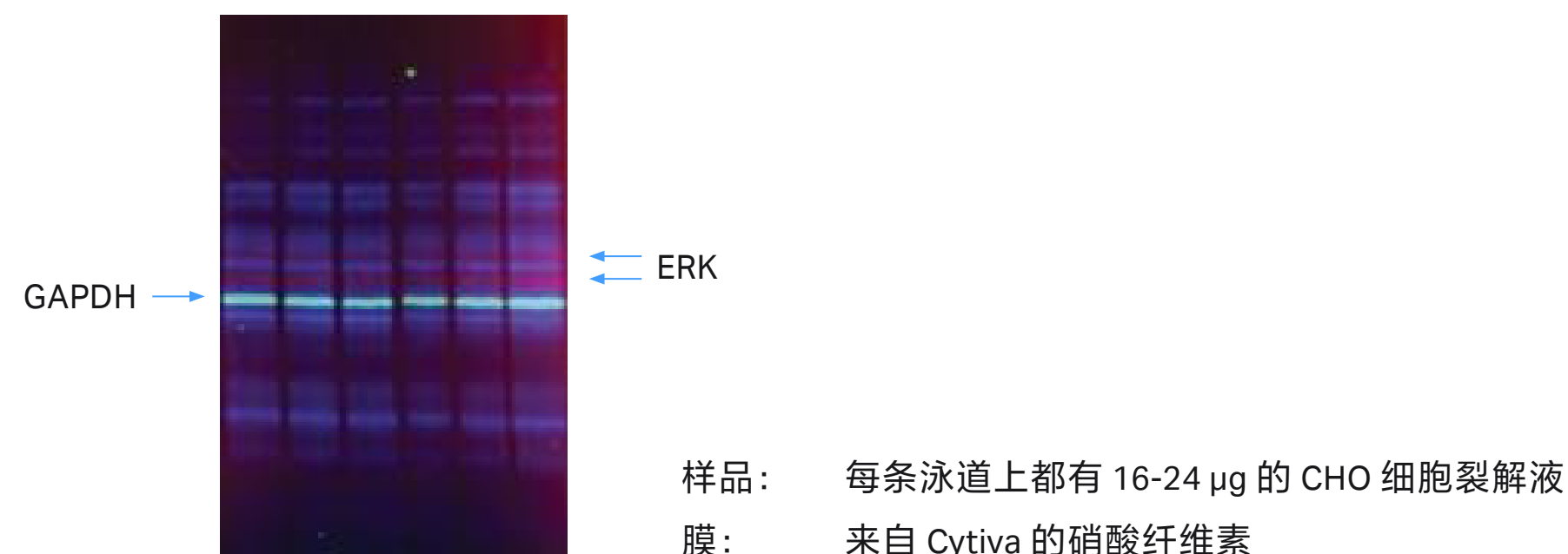
图 6.16. 用于蛋白质印迹法的硝酸纤维素膜的三色叠加图像。目标 ERK 蛋白的检测使用了红色的红外 (IR) 长波 LED 和滤光片组合，而 GAPDH 的检测则使用了绿色的红外短波通道。裂解液预先用 Cy™3 (蓝色) 标记。
