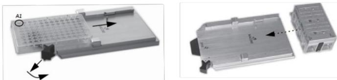
Reagent Rack 1&2 和 96/384 微孔板安装方式
